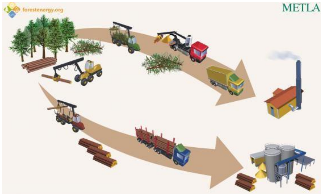
Figura nº 6: Modelo nº 7: Desembosque de restos brutos y astillado en cargadero. Fuente: Forest Energy Portal .
