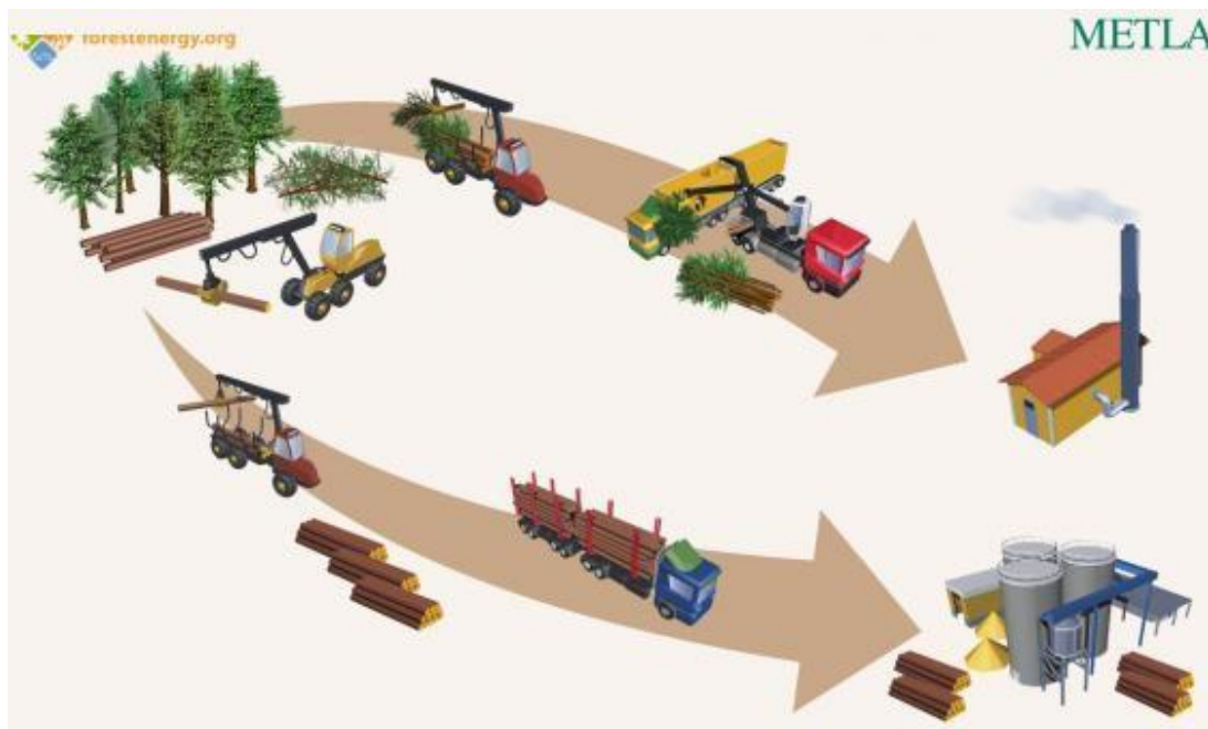
Figura nº 7: Modelo nº 8: Desembosque y transporte de restos brutos a planta. Fuente: Forest Energy Portal .
