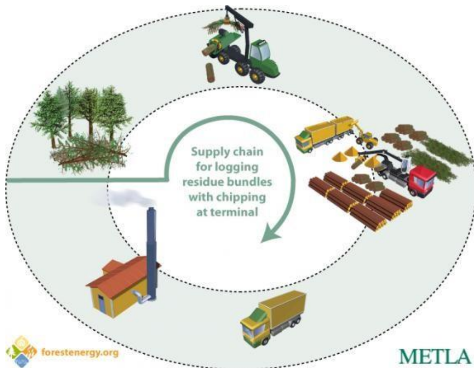
Figura nº 3: Modelo nº 1: Enfardado y astillado en planta. Fuente: Forest Energy Portal.
